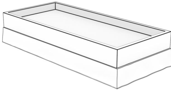
Figuur 2: Plaatsen van de schuimkern op de onderkant van de tijk.
